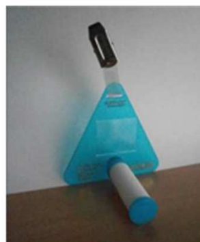
Figure 5. Cartouche RADIELLO COV monté sur le support
