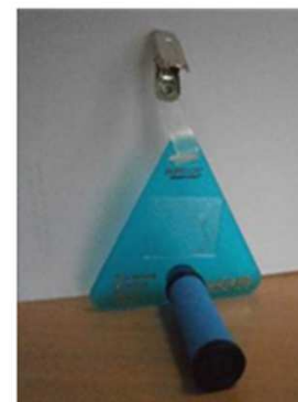
Figure 6. Cartouche RADIELLO Aldéhydes monté sur le support
